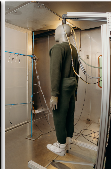
Manekin termiczny Newton w wysokogabarytowej komorze klimatyzowanej umożliwiającej ocenę termoizolacyjności odzieży w różnych warunkach atmosferycznych
