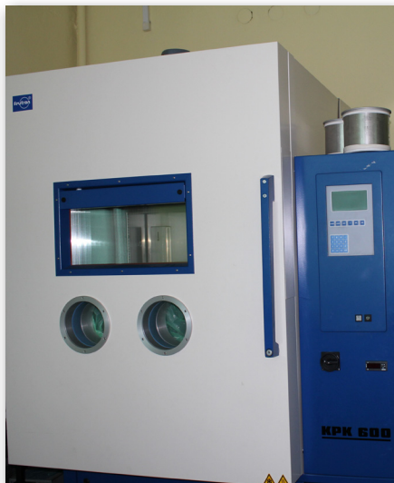
Urządzenie do pomiaru czasu połowicznego zaniku ładunku elektrycznego z naelektryzowanych tekstyliów oraz komora klimatyzowana.
