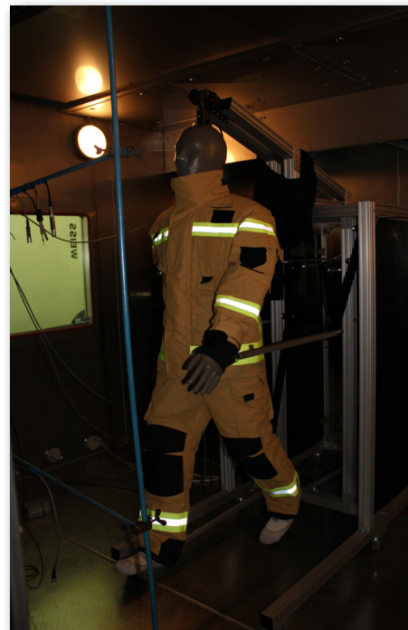
Manekin termiczny Newton w wysokogabarytowej komorze klimatyzowanej umożliwiającej ocenę termoizolacyjności odzieży w różnych warunkach atmosferycznych
