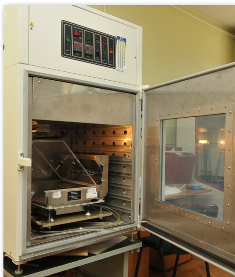
Model ludzkiej skóry w komorze klimatyzowanej umożliwiający pomiar oporu cieplnego oraz oporu pary wodnej dla tekstyliów odzieżowych
