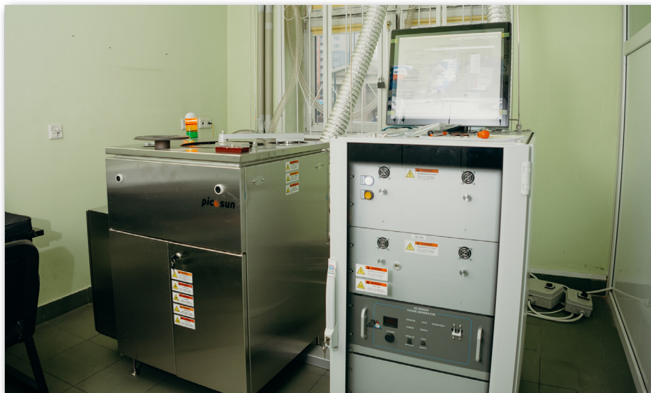
System do osadzania warstw atomowych ALD (z ang. Atomic Layer Deposition) na powierzchni ciał stałych
