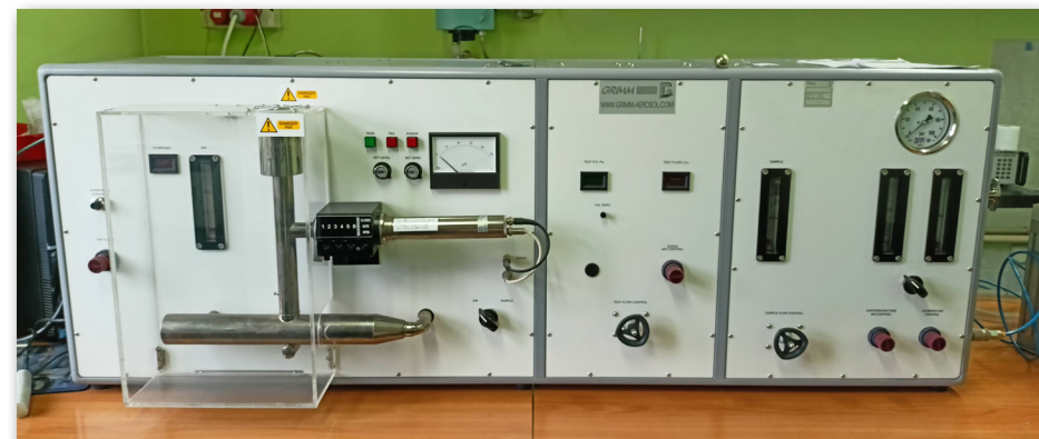
Aparat do badania właściwości filtracyjnych metoda chlorku sodu Grimm 1100 AL
