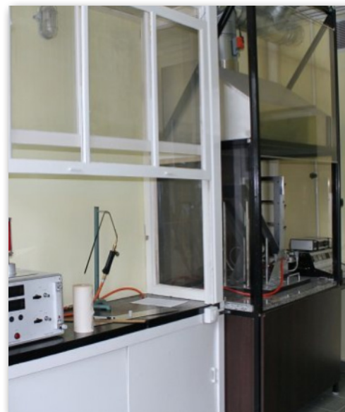
Stanowisko do badania palności metodą wskaźnika tlenowego
