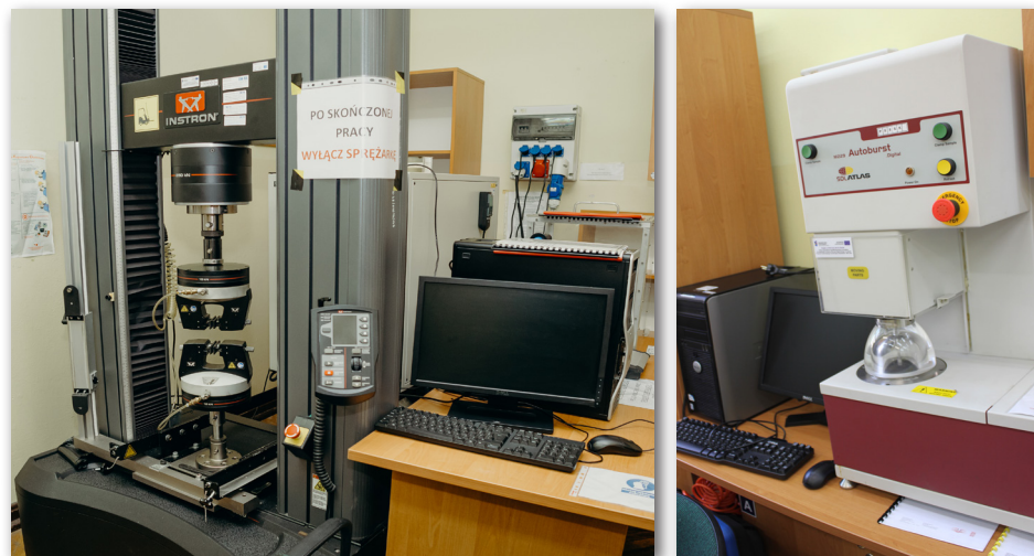
Maszyna wytrzymałościowa o maksymalnej obciążalności do 250 kN (INSTRON 3119-410)
