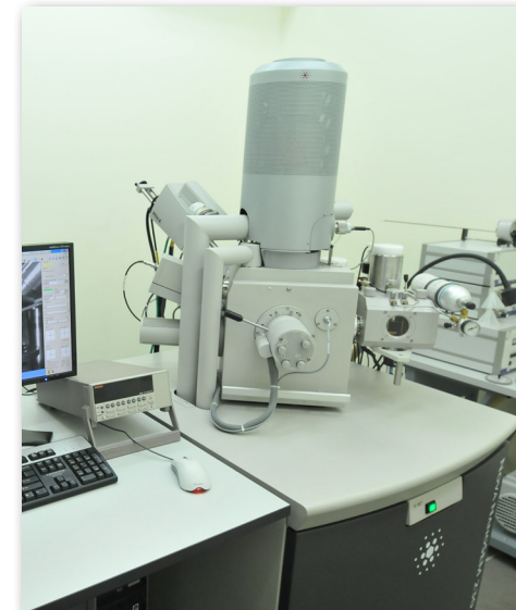
Wysokorozdzielczy skaningowy mikroskop elektronowy NOVA nanoSEM 230 firmy FEI z mikroanalizatorem rentgenowskim EDS Apollo firmy EDAX
