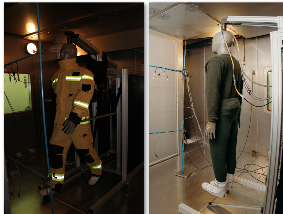
Manekin termiczny Newton w wysokogabarytowej komorze klimatyzowanej umożliwiającej ocenę termoizolacyjności odzieży w różnych warunkach atmosferycznych
