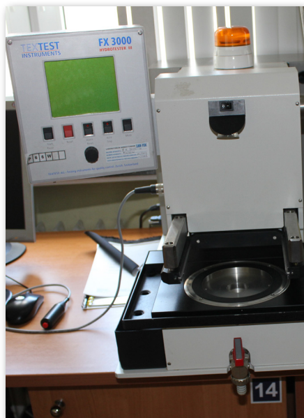
FX 3000 Hydrotester III (TexTest Instruments) umożliwiający badanie wodoszczelności tekstyliów metodą ciśnienia hydrostatycznego
