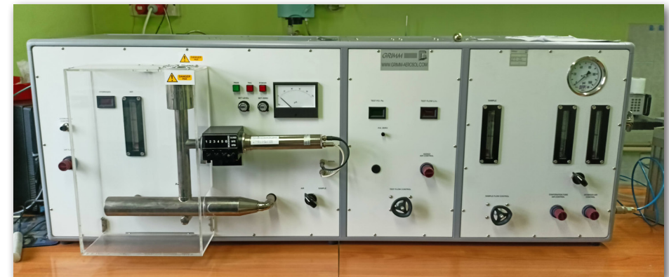
Aparat do badania właściwości filtracyjnych metoda chlorku sodu Grimm 1100 AL
